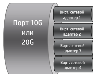
Рис. 2. Один сетевой порт, обеспечивающий работу четырех виртуализированных сетевых адаптеров
