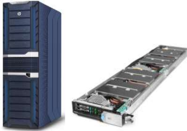
Рис. 4. Стойка HP Apollo f8000 и сервер ProLiant XL730f Gen9
