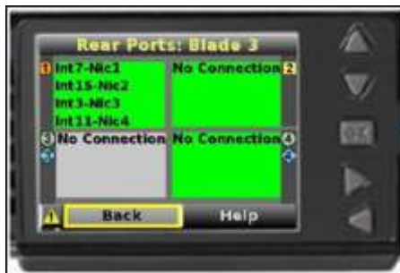
Рис. 2. Дисплей System Insight Display, используемый для управления корпусом HP ProLiant c-класса.
