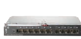
Модуль HP Virtual Connect Flex 10/10D
