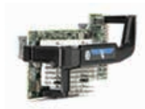
2-портовый адаптер HP FlexFabric 20 Гбит/с 630FLB
