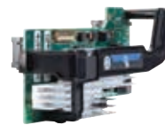
2-портовый адаптер HP Ethernet 10Gb 570FLB
